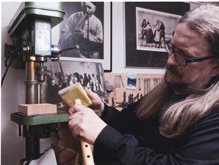
kuva 52. Putken lyhentäminen biomalla. Kuva Rauno Nieminen.
